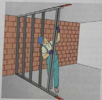
Rys. 6.12. Mocowanie słupków rusztu (profilu CW)
